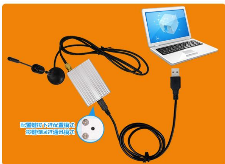
数传模块USB接口连接示意图
